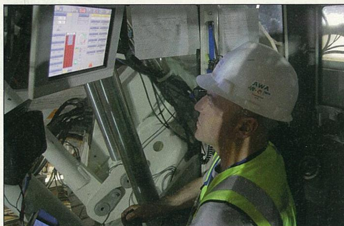
Figura 1 - Il computer "stand alone" con touch screen a colori montato a bordo di una perforatrice Soilmec
